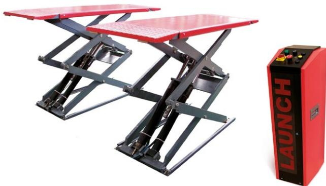
Makazasta dizalica nosivosti 3,2 tone je dizajnirana za postavljanje na ravne površine i može da podže gotovo sve vrste putničkih automobila i kombija. Ultra tanka konstrukcija od 110 mm omogućava podizanje sportskih automobila i nisko-profilnih vozila.
