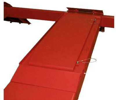
Hidraulična četvorostubna dizalica nosivosti 4 tone sa primenom u podizanju raznih vozila u garažama i radionicama. Ova dizalica je opremljena dodatnom makazastom dizalicom (nosivosti 2 tone) kao i kliznim i okretnim pločama za reglažu trapa
