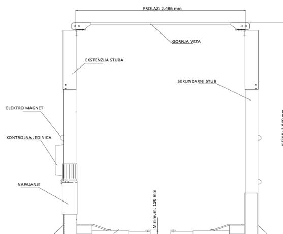
Hidraulična dvostubna dizalica sa gornjom vezom, nosivosti 4 tone i elektromagnetnim otključavanjem je odlična u podizanju SUV vozila, kombija i drugih vozila do 4 tone. Dizajnirana na osnovu međunarodnog standarda i potvrđena sa CE sertifikatom.
