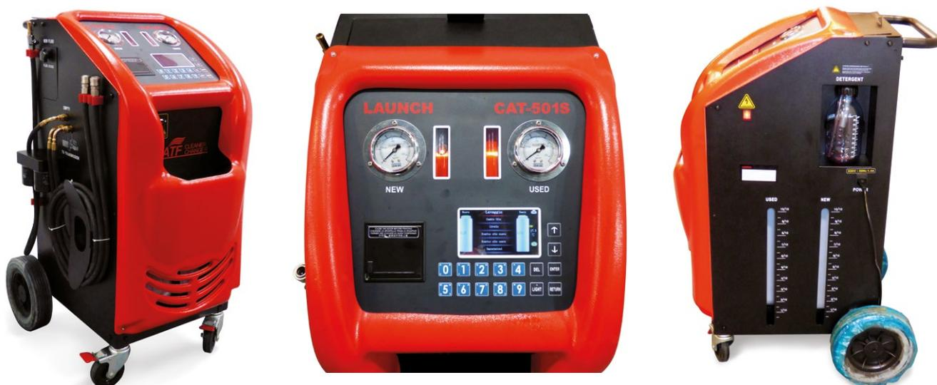
Bez aparata se zameni maksimalno oko 30-50% tečnosti jer nije moguće manuelnim putem izbaciti ulje koje je u mnogim kanalima, pločama, konverteru, itd. Kod manualnog punjenja automatskih menjača se izuzetno teško kontroliše prekomerno punjenje ili manjak tečnosti i lako možemo izazvati štetu na automatskom menjaču.
