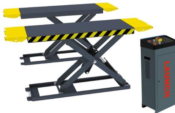
Srednje visinska makazasta dizalica nosivosti 3 tone je dizajnirana za postavljanje na ravne površine i može da podže gotovo sve vrste putničkih automobila i kombija. Ultra tanka konstrukcija od 105 mm omogućava podizanje sportskih automobila i nisko-profilnih vozila.
