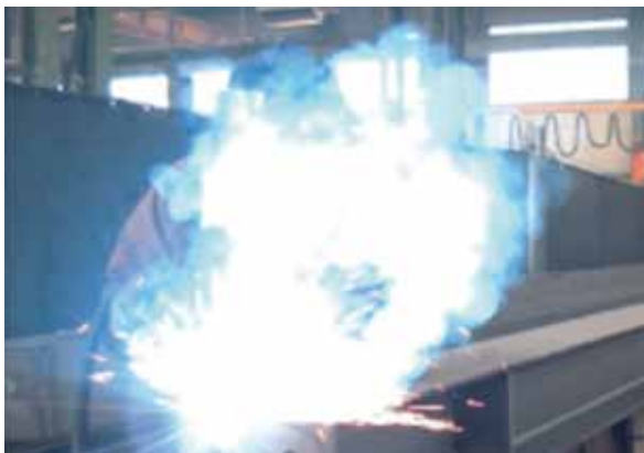
Prethodno: Jaka proizvodnja dima sa konvencionalnim lukom.
