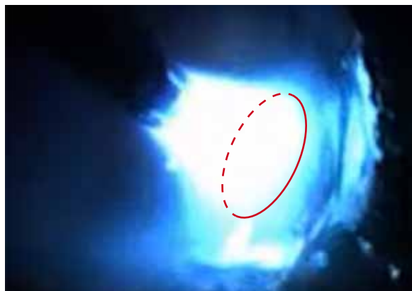
Sada: FOCUS.ARC Koncentrisani luk sa energijom u centru
