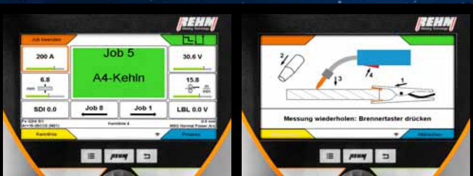
Relevantni parametri su uvek u prvom planu, perator može da ih prepozna i sa udaljenosti.
