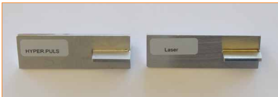
Ugaono zavarivanje za farmaceutsku industriju | bez dodatnog materijala, ručni gorionik
