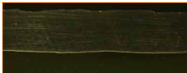
Popravno zavarivanje sa DualWave-om. Značajno manje pora.
